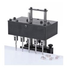
Der Bernardo Reihenbohrkopf 14-1106 ist ein professionelles Werkzeug zum Bohren von Löchern in Möbeln und anderen Holzprodukten. Dieser Reihenbohrkopf ist mit fünf Spindeln ausgestattet, zum Ausführen einer Serie von fünf Löchern gleichzeitig mit einem Achsabstand von 32 mm. Diese Ausrüstung wird beim Bohren von Möbelseitenteilen als auch zur Befestigung der Scharnierbasis verwendet.
