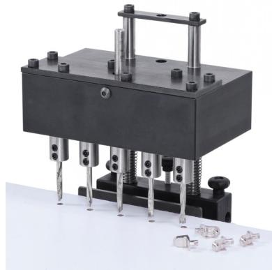
Der Bernardo Reihenbohrkopf 32 mm ist mit Aufnahme für Bohrmaschinen Bohrmasken ausgestattet. Dieser Reihenbohrkopf ist mit fünf Spindeln ausgestattet, zum Ausführen einer Serie von fünf Löchern gleichzeitig mit einem Achsabstand von 32 mm. Diese Ausrüstung wird beim Bohren von Möbelseitenteilen als auch zur Befestigung der Scharnierbasis verwendet.
