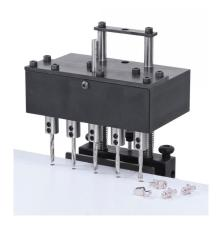
Der Bernardo Reihenbohrkopf 32 mm ist mit Aufnahme für Bohrmaschinen Bohrmasken ausgestattet. Dieser Reihenbohrkopf ist mit fünf Spindeln ausgestattet, zum Ausführen einer Serie von fünf Löchern gleichzeitig mit einem Achsabstand von 32 mm. Diese Ausrüstung wird beim Bohren von Möbelseitenteilen als auch zur Befestigung der Scharnierbasis verwendet.
