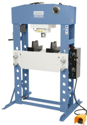
Die Bernardo PWK 100 F Pneumatische Werkstattpressen sind ideal geeignet zum Ausrichten von Achsen, Wellen usw., aber auch zum Ein- und Auspressen von Bolzen, Lagern, Buchsen uvm. Durch das serienmäßige Fußpedal bleiben die Hände frei für das Werkstück. Die Pressen haben einen geschweißten Stahlrahmen für hohe Beanspruchung und hohe Standfestigkeit.
