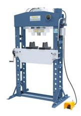
Die Bernardo PWK 75 F Pneumatische Werkstattpressen ist eine leistungsstarke Presse für verschiedene Anwendungen. Die Presse verfügt über eine Druckkraft von 75 to und einen Kolbenhub von 250 mm. Der Tisch bietet eine Breite von 280 mm und einen Durchgang von 800 mm.
