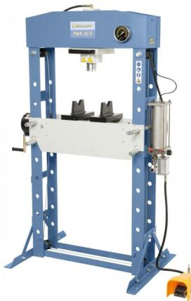
Die Bernardo PWK 50 F Pneumatische Werkstattpressen ist eine leistungsstarke Lösung für Handwerks- und Reparaturbetriebe. Sie bietet ein optimales Preis-Leistungsverhältnis durch ihre rationelle Bauart und ist vielseitig einsetzbar. Die Pressen sind serienmäßig mit Seilwinde für eine einfache Höhenverstellung des Auflagetisches ausgestattet. Der Kolben kann wahlweise manuell oder pneumatisch gestellt werden.
