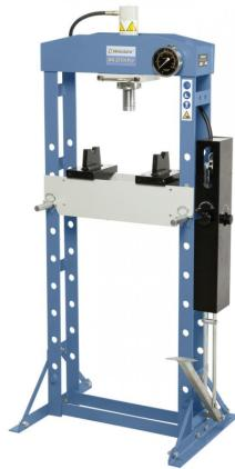
Die Bernardo WK 20 FH Pro Werkstattpressen ist eine leistungsstarke Presse für verschiedene Anwendungen. Sie verfügt über eine Druckkraft von 20 to und einen Kolbenhub von 185 mm. Der Pressentisch ist höhenverstellbar und verfügt über eine Arretierungsbolzen. Die Presse ist serienmäßig mit Fußpedal und hydraulischer Handpumpe für die Kolbenzustellung ausgestattet.
