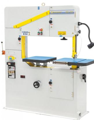
Die Vertikalbandsäge VMS 1000 eignet sich zum Sägen von nahezu allen sägbaren Materialien (zB. Stahl, Kunststoff, NE-Metalle, Buntmetalle, ...). Ihren Einsatzbereich findet dieses Modell vorwiegend in der allgemeinen Produktion, im Werkzeug- und Vorrichtungsbau, bei der Herstellung von Stanz- und Schnittwerkzeugen.
