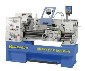
Die Universaldrehmaschine Smart 410 Vario eignet sich zur Ausführung von leichten und mittelschweren Dreharbeiten. Schon die Grundausstattung beinhaltet alle wichtigen Zubehöre (3-Backenfutter, Lünetten, Wechselräder, 3-Achs-Positionsanzeige,...) wodurch diese Maschine universell einsetzbar ist. Weiters ist dieses Modell mit einer stufenlos regelbaren Spindeldrehzahl bis 3000 U/min ausgestattet, dadurch kann die Drehzahl optimal an das Werkstück und die Vorschubgeschwindigkeit angepasst werden.
