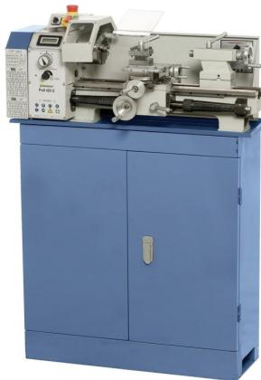
Die Tischdrehmaschine Profi 400 G ist - im Vergleich zur Profi 400 V - mit einem Vorgelege ausgestattet, wodurch ein Wechseln der Drehzahlstufe mittels Keilriemen entfällt. Die eingestellte Drehzahl kann schnell und einfach über die digitale Drehzahlanzeige abgelesen werden.
