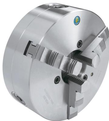
Das Bernardo Präzisions-3-Backenfutter PO3 - 160 ist ein hochpräzises Dreibackendrehfutter, das für Dreh- und Schleifmaschinen geeignet ist. Es verfügt über eine Zentrieraufnahme nach DIN 6350 und ist aus Stahl gefertigt, um höhere Drehzahlen und eine längere Lebensdauer zu ermöglichen.
