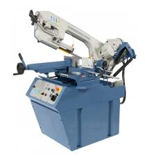
Das Modell MBS 350 DG-VR PRO ist eine präzise Horizontalbandsäge für den universellen Einsatz. Die Merkmale dieser Maschine sind der schwenkbare Sägebügel für Doppelgehrungsschnitte von -45° bis +60°, der drehbare Schraubstock sowie die stufenlose Schnittgeschwindigkeit.
