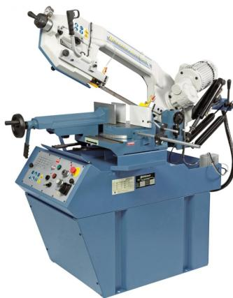
Die Doppelgehrungsbandsäge MBS 315 DG-VR PRO hat den Vorteil, dass sich der drehbare Schraubstock gleichzeitig mit dem Sägebügel mitbewegt. Die stufenlose Schnittgeschwindigkeit, die Umstellung von automatischen auf manuellen Betrieb sowie die Bandspannungsanzeige mittels Manometer sind weitere Argumente, die diese Maschine für jeden professionellen Anwender interessant machen.
