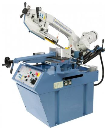
Die kompakte Doppelgehrungsbandsäge MBS 300 DG-V PRO ist serienmäßig mit einer Vorrichtung zum Umstellen auf manuellen Sägebetrieb ausgestattet. Weitere Merkmale dieses Modells sind der verschiebbare Schraubstock mit Schnellarretierung, das Manometer für die Bandspannung sowie die Auflagedruckregulierung des Sägebügels mittels Regelventil an der Vorderseite der Maschine. Das Modell MBS 300 DG-V PRO hat eine variable Schnittgeschwindigkeit zur optimalen Anpassung an das Werkstück.
