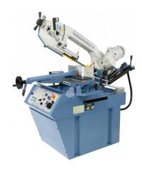
Die kompakte Doppelgehrungsbandsäge MBS 300 DG-V PRO ist serienmäßig mit einer Vorrichtung zum Umstellen auf manuellen Sägebetrieb ausgestattet. Weitere Merkmale dieses Modells sind der verschiebbare Schraubstock mit Schnellarretierung, das Manometer für die Bandspannung sowie die Auflagedruckregulierung des Sägebügels mittels Regelventil an der Vorderseite der Maschine. Das Modell MBS 300 DG-V PRO hat eine variable Schnittgeschwindigkeit zur optimalen Anpassung an das Werkstück.
