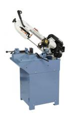
Die kostengünstige Metallbandsäge EBS 150 BC mit umfangreicher Grundausstattung (Untergestell, Kühlmitteleinrichtung, Sägeband, ...) ist die ideale Maschine für den kostenbewussten Anwender. Der Sägebügel ist bis 60° schwenkbar, dadurch ermöglicht dieses Modell ein platzsparendes Arbeiten bei langen Werkstücken.
