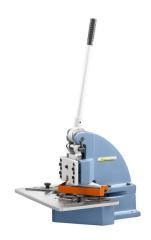
Die Bernardo AK 150 Manuelle Ausklinkmaschinen sind ideal für die Bearbeitung von Blechen. Die Maschinen haben eine maximale Blechstärke von 1,5 mm bei 400 N/mm² und eine maximale Stanzlänge von 150 x 150 mm bei 90°. Der Schnittwinkel beträgt 90° und die Hubverstellung 20 mm. Die Tischgröße beträgt 457 x 305 mm.
