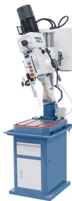
Das Modell GB 35 TV Vario ist eine Tischbohrmaschine mit stufenloser Drehzahlregelung, automatischem Pinolenvorschub und digitaler Drehzahlanzeige. Für einen erweiterten Einsatzbereich verfügt die Maschine zusätzlich über einen schwenkbaren Getriebekopf.
