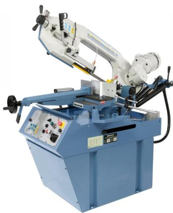
Die kompakte Doppelgehrungsbandsäge MBS 300 DG PRO ist serienmäßig mit einer Vorrichtung zum Umstellen auf manuellen Sägebetrieb ausgestattet. Weitere Merkmale dieses Modells sind der verschiebbare Schraubstock mit Schnellarretierung, das Manometer für die Bandspannung sowie die Auflagedruckregulierung des Sägebügels mittels Regelventil an der Vorderseite der Maschine.
