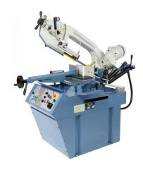
Die kompakte Doppelgehrungsbandsäge MBS 300 DG PRO ist serienmäßig mit einer Vorrichtung zum Umstellen auf manuellen Sägebetrieb ausgestattet. Weitere Merkmale dieses Modells sind der verschiebbare Schraubstock mit Schnellarretierung, das Manometer für die Bandspannung sowie die Auflagedruckregulierung des Sägebügels mittels Regelventil an der Vorderseite der Maschine.
