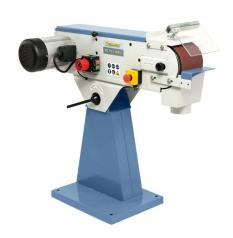
Die Bernardo MS 150 x 2000 S Bandschleifmaschinen bietet eine gute Schleifleistung durch hohe Bandgeschwindigkeit. Sie verfügt über eine schnellverstellbare Waagrecht- und Schrägposition sowie eine durchgehende Planschleifläche für optimales Schleifen von langen Werkstücken. Die gleichbleibende Bandspannung wird durch eine federbelastete Spanneinrichtung gewährleistet.
