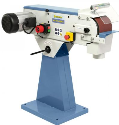
Die Bernardo MS 150 x 2000 S Bandschleifmaschinen bietet eine gute Schleifleistung durch hohe Bandgeschwindigkeit. Sie verfügt über eine schnellverstellbare Waagrecht- und Schrägposition sowie eine durchgehende Planschleiffläche für optimales Schleifen von langen Werkstücken. Die gleichbleibende Bandspannung wird durch eine federbelastete Spanneinrichtung gewährleistet.
