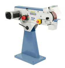
Die Bernardo MS 75 x 2000 S Bandschleifmaschinen ist eine leistungsstarke Maschine für das Schleifen von Kanten, Flächen und Rundschleifen. Durch die hohe Bandgeschwindigkeit von 29 m/sek. und die gleichbleibende Bandspannung durch die federbelastete Spanneinrichtung, bietet diese Maschine eine gute Schleifleistung. Die durchgehende Planschleiffläche ermöglicht das optimale Schleifen von langen Werkstücken.
