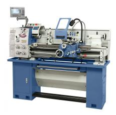
Die Leit- und Zugspindeldrehmaschine Standard 165 Top überzeugt durch ihre stabile Konstruktion und einfache Handhabung. Schon die Grundausstattung beinhaltet alle wichtigen Zubehöre, wodurch diese Maschine universell einsetzbar ist. Zusätzlich verfügt dieses Modell über einen Schnellwechselhalter mit 4 Einsätzen.
