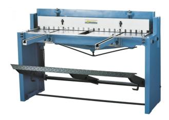
Der Bernardo FBS 1320 Fußblechscheren ist ein professionelles Werkzeug für die Metallverarbeitung. Die Maschine bietet eine Schnittlänge von 1320 mm und kann Bleche mit einer Maximalstärke von 1,25 mm bei 400 N/mm² schneiden. Der Tisch ist 800 mm hoch und der Hinteranschlag kann von 0 bis 700 mm eingestellt werden. Die Abmessungen der Maschine betragen 1550 mm in der Länge, 1600 mm in der Tiefe (mit Hinteranschlag) und 1060 mm in der Höhe. Das Gewicht der Maschine beträgt etwa 510 kg.
