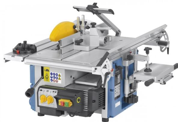
Die handliche Universal-Kombimaschine CWM 150 bietet eine Vielzahl an Anwendungsmöglichkeiten auf kleinstem Raum - Abrichthobeln, Dickenhobeln, Sägen, Fräsen, Bohren. Durch die kleine und kompakte Bauweise ist dieses Modell für den Hobbybastler optimal geeignet.
