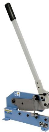
Die Bernardo HS 12 Handschere ist ideal zum Schneiden von Blechen, Rund- und Flachstahl. Sie ist eine Standardschere für Installateure, Schlossereien und Lehrwerkstätten. Durch die günstige Schneidengeometrie ermöglicht sie kraftschonendes Schneiden. Der Maschinenkörper besteht aus stabilen Stahlplatten und hat Bohrungen zur Befestigung auf der Werkbank.
