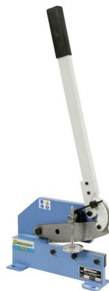
Die Bernardo HS 8 Handschere ist ideal zum Schneiden von Blechen, Rund- und Flachstahl. Sie ist eine Standardschere für Installateure, Schlossereien und Lehrwerkstätten. Durch die günstige Schneidengeometrie ermöglicht sie kraftschonendes Schneiden. Der Maschinenkörper besteht aus stabilen Stahlplatten und ist mit Bohrungen zur Befestigung auf der Werkbank versehen.
