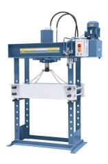
Die Bernardo BHP 100 Hydraulische Werkstattpresse mit verschiebbarem Zylinder ist ein leistungsstarkes Werkzeug für verschiedene Anwendungen. Die Presse verfügt über eine Druckkraft von 100 to und einen maximalen Druck von 215 bar. Der Kolbenhub beträgt 400 mm und der Kolbendurchmesser 90 mm. Die Tischbreite beträgt 635 mm und die maximale Arbeitshöhe 930 mm. Die Vorlaufgeschwindigkeit beträgt 10 mm/sek. und die Rücklaufgeschwindigkeit 14 mm/sek. Der Motor verfügt über eine Leistung von 4,0 kW.
