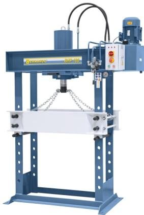
Die Bernardo BHP 100 Hydraulische Werkstattpresse mit verschiebbarem Zylinder ist ideal geeignet zum Ausrichten von Achsen, Wellen usw., aber auch zum Ein- und Auspressen von Bolzen, Lagern, Buchsen uvm. Sie ist serienmäßig mit einem seitlich verschiebaren Zylinder ausgestattet und verfügt über eine Verstellvorrichtung für die Höhenverstellung des Arbeitstisches.
