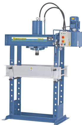
Die Bernardo BHP 80 Hydraulische Werkstattpresse mit verschiebbarem Zylinder ist ideal geeignet zum Ausrichten von Achsen, Wellen usw., aber auch zum Ein- und Auspressen von Bolzen, Lagern, Buchsen uvm. Sie ist serienmäßig mit einem seitlich verschiebaren Zylinder ausgestattet und verfügt über eine Verstellvorrichtung für die Höhenverstellung des Arbeitstisches.
