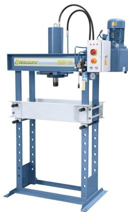
Die Bernardo BHP 50 Hydraulische Werkstattpresse mit verschiebbarem Zylinder ist ideal geeignet zum Ausrichten von Achsen, Wellen usw., aber auch zum Ein- und Auspressen von Bolzen, Lagern, Buchsen uvm. Sie ist serienmäßig mit einem seitlich verschiebaren Zylinder ausgestattet und verfügt über eine Verstellvorrichtung für die Höhenverstellung des Arbeitstisches.
